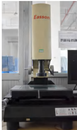
2D 投影測量儀 精度は 0.005mm
