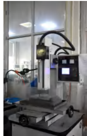
Sodick HSW EDM 精度は -0.01mm 以内
