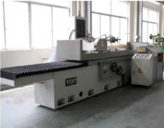
高精度平面研削盤 0.01mm 以内の精度
