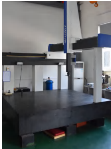
大型三次元測定機 CMM、ストロークは 1.5 * 2 * 1m、精度は 0.0019mm、高速プログレッシブダイヤモンド型及びコアの製品を検査できます
