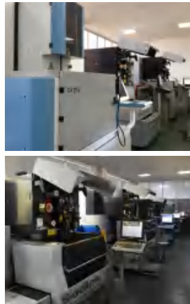
Sodick WEDM-LS 速度は 0.2m/s 以下、精度は 0.001mm 以内
